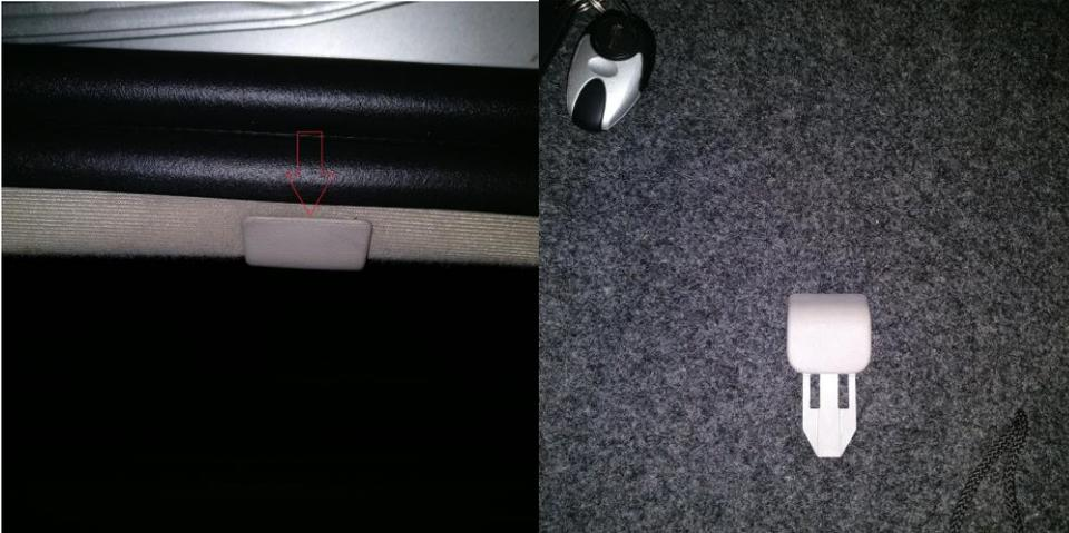
4. Nehmt die Kabel aus den kabelhaltern heraus (2 Stück), diese befinden sich zwischen Karosserie und Dach Himmel, folgt mit euren fingern einfach von den Antennen Verbindungen aus den Kabel bis hin zur Antenne.
