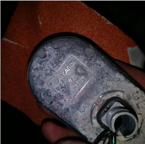
**Hinweis:** Auf dem Bild sieht man meinen antennenfuß mit der Vulkanisierten? Dichtung (Untere Hälfte, oben ist schon abgeschliffen) die eigentlich keine Dichtung ist, die eigentliche Dichtung befindet dort wo der rote Pfeil drauf zeigt und verschleißt nur ziemlich selten, bei mir war sie nach 9 Jahren noch wie neu.
