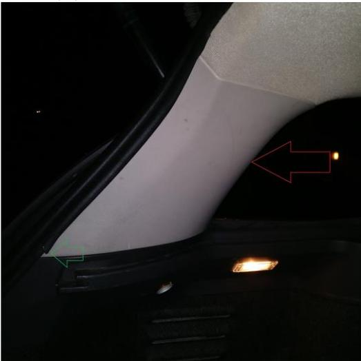
**Hinweis:** Entfernt ggf. den Dichtungsgummi (Gesteckt) bis zum grünen Pfeil, ich habe es mit Dichtungsgummi gemacht und dabei den Gummi zerstört, da dort wo der grüne Pfeil hinzeigt sich eine spitze kannte von der Verkleidung befindet.
