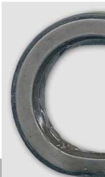
▲ Gefettete PTFE-Dichtlippe als Ausfallursache.
