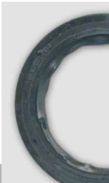
▲ Beschädigte PTFE-Dichtlippe als Ausfallursache.
